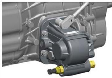
4.9 - После выставления зазора, необходимо закрутить гайки, полностью выдерживая моменты затяжки, приведенные в разделе 3, таблице 3.
