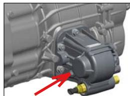
4.7 - Установите КОМ и наживите гайки для выставления зазора зубчатого зацепления шестерен КОМ-КПП
