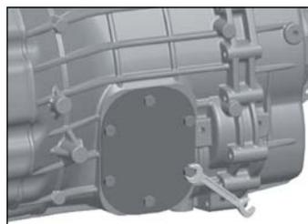
4.1 - Выкрутите пробку сливного отверстия и слейте масло из КПП. Закрутите сливную пробку назад с усилием, указанным в руководстве по эксплуатации КПП.
